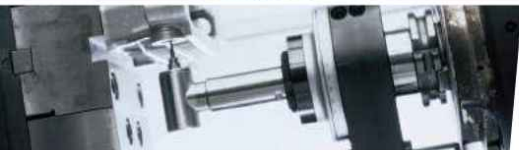
MOLTIPLICATORE AD ARIA AIR DRIVEN SPEEDER Max 60.000 RPM
